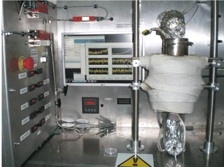
**Abbildung 3.13.** Foto des überarbeiteten TPO-Prüfstands. FTIR-Spektrometer, Waschflasche und Diffusionstrockenrohr befinden sich hinter der Wand. Die H<sub>2</sub>O-Dosierung und weitere Gasleitungen befinden sich unterhalb der Arbeitsfläche.
