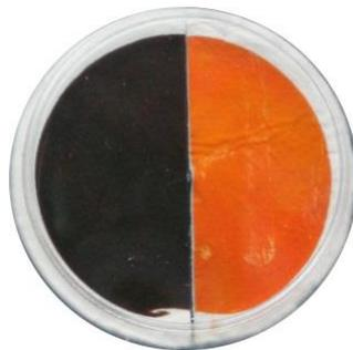
Abbildung 4.10. Mit eisenhaltigem Ruß beladener Quarzfaserfilter vor TPO (links, schwarz) und nach TPO (rechts, orange) mit Rückstand von Hämatit  $\alpha$ -Fe<sub>2</sub>O<sub>3</sub>.
