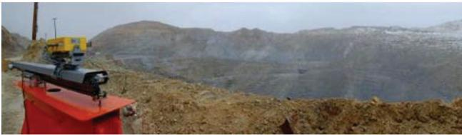
Abb. 7: Installierte Messeinheit eines Radarsystems (System IBIS-M) zur Aufnahme einer Tagebauböschung nach Farina (2010)
