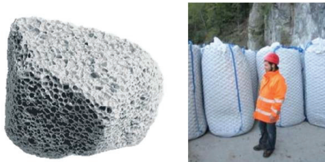
Abb. 1: Glasschaumschotterkorn (links) und mit einem hochfesten Stahldrahtgeflecht ummantelte Dämpfungsmodule (rechts).
