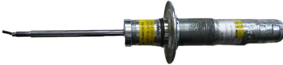
Abbildung 3.3: Der Zweirohrdämpfer der Hinterachse.
