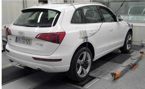
Abbildung 3.2: Das Versuchsfahrzeug auf dem Hydropulsprüfstand.
