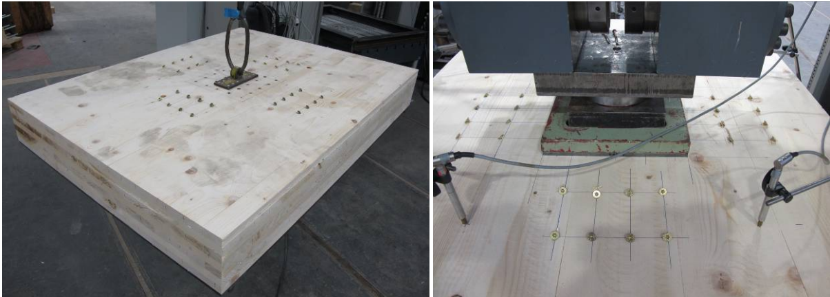
Abbildung 8-5: Prüfkörper mit Schub- und Querdruckverstärkungen (Serie Typ 189_P - A-1)
