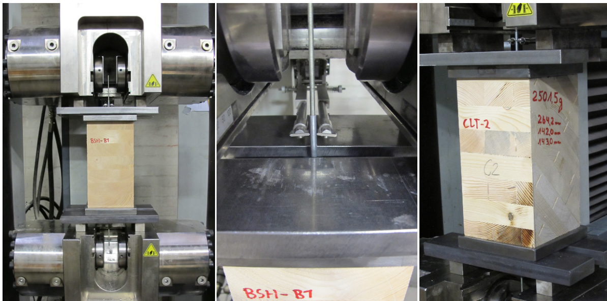
Abbildung 5-9: Versuchsdurchführung zur Ermittlung der Verformungsänderung der Prüfkörper
