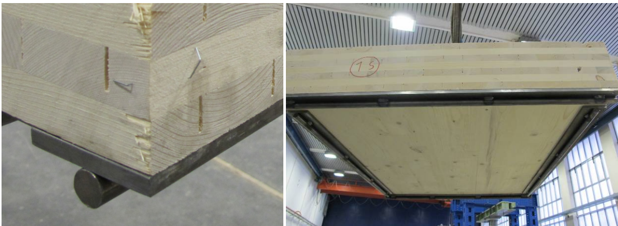
Abbildung 8-6: Umlaufende, gelenkige Linienlager
