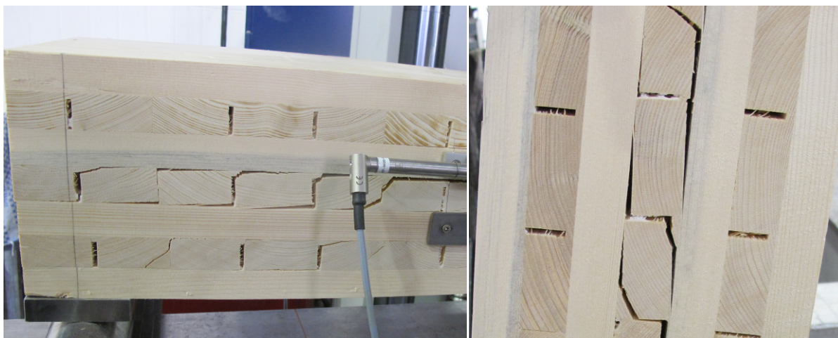
Abbildung 5-28: Bruchbilder an Balken- und Schubelementen, Typ 189-0
