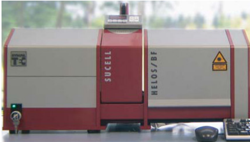
Abbildung 3.3: Bestimmung von Partikelgrößenverteilungen mittels Nassdispergierung [79]
