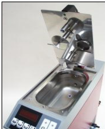
Abbildung 3.4: Edelstahlbecken der Nassdispergierung [80]
