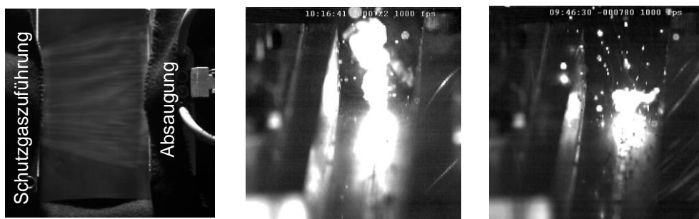
Abbildung 89: Einfluss der Schutzgaszuführung und der Schweißrauchabsaugung auf die Prozessstabilität; links: Laminare Gasströmung zwischen Zuführung und Absaugung; Mitte: Schweißprozess ohne Schutzgaszufuhr und Absaugung; rechts: Schweißprozess mit optimierter Schutzgaszuführung und Absaugung
