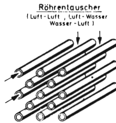
Abb. 2: Merkmale von Wärmetauschern zur Wärmerückgewinnung aus der Tierhaltung
