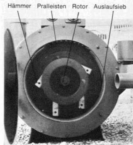
Abb. 464 Hammermühle (geöffnet)
