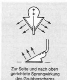
Abb. 26 Funktionsprinzip des Grubbers
