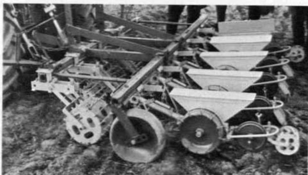
Abb. 188 Schmale Krümelwalzen lockern zusätzlich den Saatstreifen und können einen Arbeitsgang bei der Saatbettbereitung ersparen
