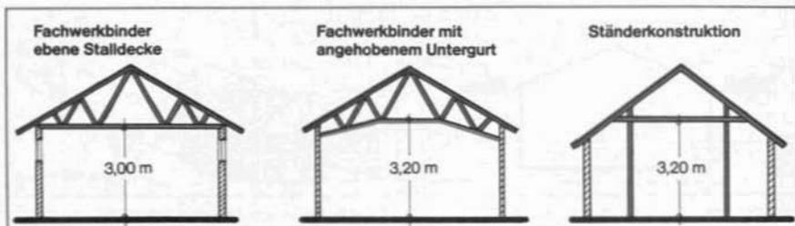
Abb. 610 Konventionelle Bauweise mit unterschiedlicher Dach- bzw. Deckenkonstruktion (nach ALB)
