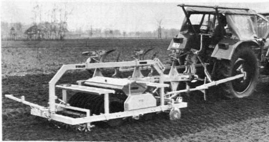
Abb. 62 Die Sävorrichtung läßt sich auch auf den Pflughnachläufer aufbauen
