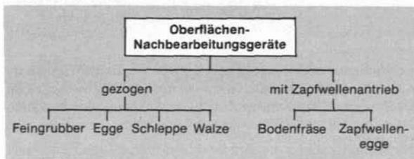
Abb. 34 Einteilung der Oberflächen-Nachbearbeitungsgeräte
