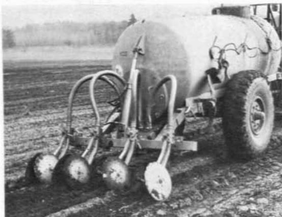
Kombination von Bodenbearbeitungswerkzeugen mit eingebauten Ableitungsrohren. Die Geruchsfreiheit ist erreicht, wenn der Flüssigmist vollkommen mit Boden abgedeckt ist. Dieses Verfahren eignet sich nur für Ackerland. Es verursacht einen deutlich erhöhten Kraftbedarf (20–25 kW bei 2–2,5 m Arbeitsbreite). Der Füllstand im Tank muß unbedingt vom Fahrersitz aus zu kontrollieren sein.
