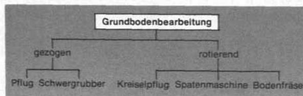
Abb. 2 Maschinen und Geräte für die Grundbodenbearbeitung
