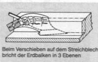
Abb. 4 Grundprinzip der Scharpflug-Arbeitsweise
