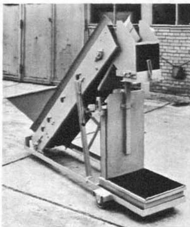
Den Anforderungen des Speisekartoffelmarktes entsprechend werden **Bürst-** und **Waschmaschinen** zunehmend verwendet. Die Leistung ist abhängig vom Verschmutzungsgrad der Kartoffeln und liegt zwischen 3 und 15 t/h. Gewaschene Kartoffeln müssen unbedingt nachgetrocknet werden.
