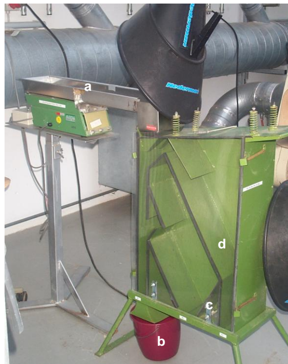
Abb. 1: Windsichter mit Förderband (a) und 3 Selektionskammern (b, c, d)
