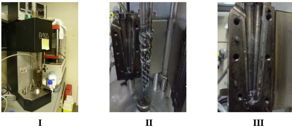
Abbildung 5.1 Daca-Microcompounder (I) mit zwei gleichläufigen Schnecken (II) und Polymerrückführung zur Regulierung der Verweilzeit (III).
