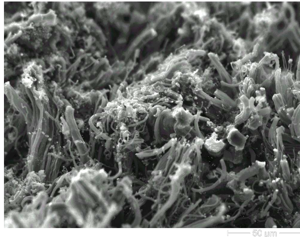
Abbildung 6.9: Kohlenstoffablagerungen in Form von Fasern auf Platindrähten zur Stromabnahme
