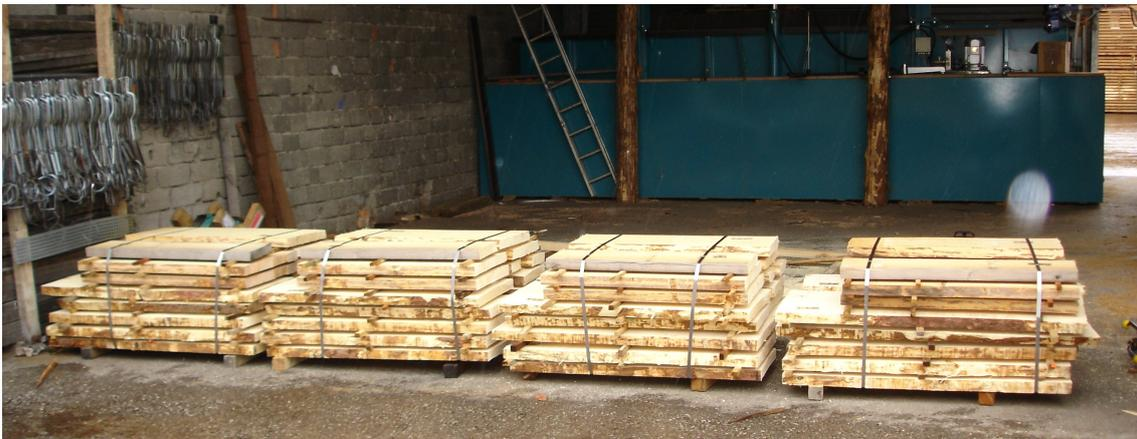
**Abbildung 4.5:** Aufgetrennte Abschnitte der Fichtenbohlen vor der Modifizierung
