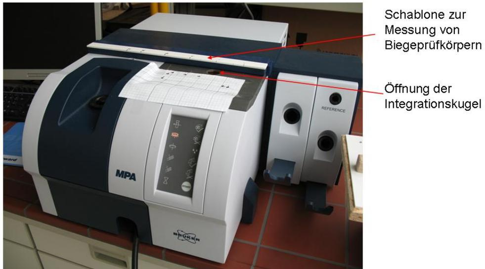
**Abbildung 4.10:** Bruker MPA NIR-Spektrometer mit Schablone zur Messung von Biegeprüfkörpern
