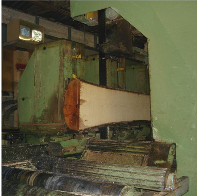
**Abbildung 4.4:** Einschnitt eines Eschen-Stammabschnittes
