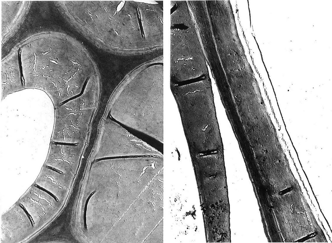
**Abbildung 3.4:** Stauchfalten in der Sekundärwand 1 von Spätholztracheiden (links) und Tracheidenwände mit Riß zwischen der Sekundärwand 1 und der Sekundärwand 2 (rechts) (24 h, 180 °C) (Fengel 1968)
