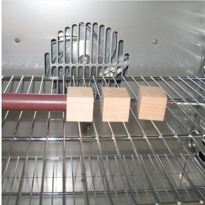
**Abbildung 4.14:** Anordnung der mit einer Prozesssonde bestückten Probe und zwei Kontrollproben im Trockenschrank
