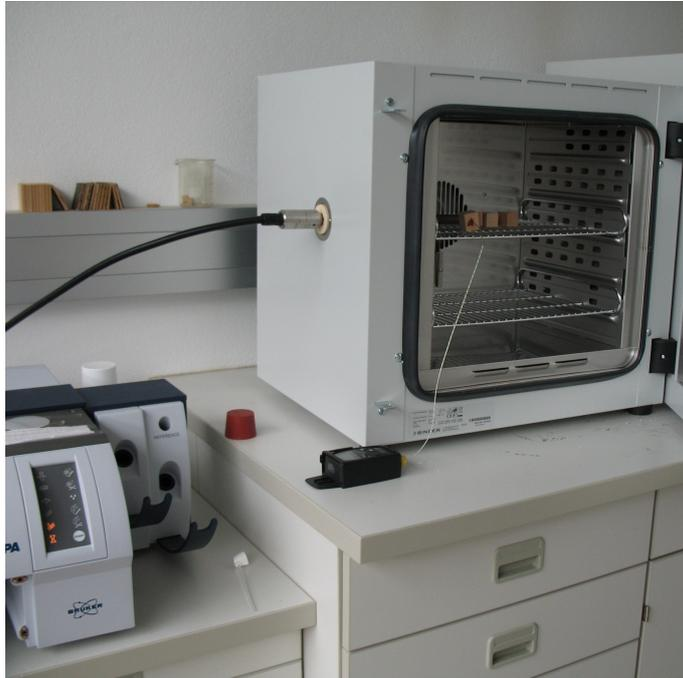
**Abbildung 4.15:** Aufbau der Prozessversuche im Labormassstab mit Spektrometer, Prozesssonde und Trockenschrank
