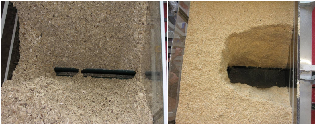
Abbildung 32: „>50 % Brückeneinsturz“ bei Hackschnitzel (links) und Sägespäne (rechts)
