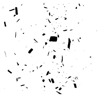
Abbildung 45: Bildrekonstruktion aus der Bildanalysemessung mit dem Haver CPA 4
