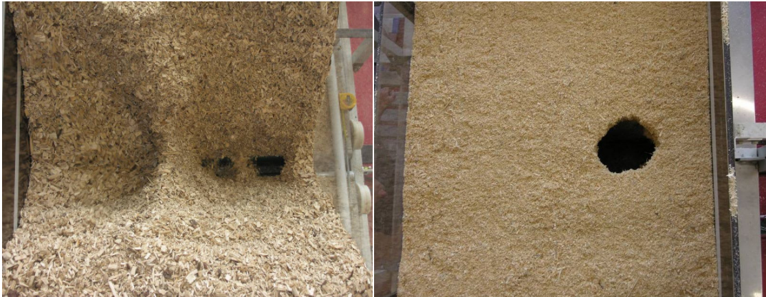
Abbildung 30: „Erster Brückeneinsturz“ bei Hackschnitzel (links) und Sägespäne (rechts)
