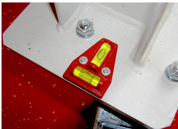
Abbildung 28: An der Rahmenkonstruktion installierte Libelle
