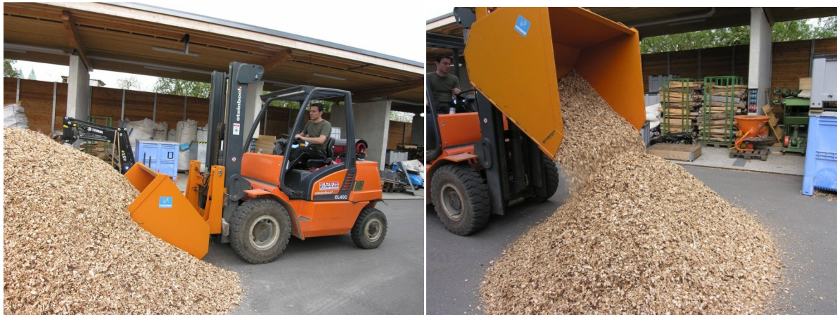
Abbildung 27: Homogenisierung des Brennstoffes
