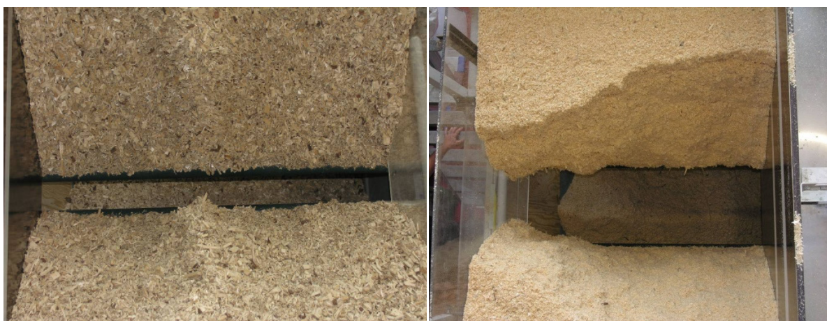
Abbildung 33: „100 % Brückeneinsturz“ bei Hackschnitzel (links) und Sägespäne (rechts)
