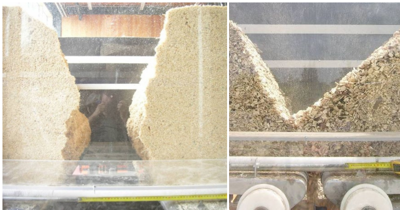
Abbildung 38: Steile Abbruchkante bei Sägespäne (links) und flache Abbruchkante (kurz vor komplettem Brückeneinsturz) bei Hackschnitzeln (rechts)
