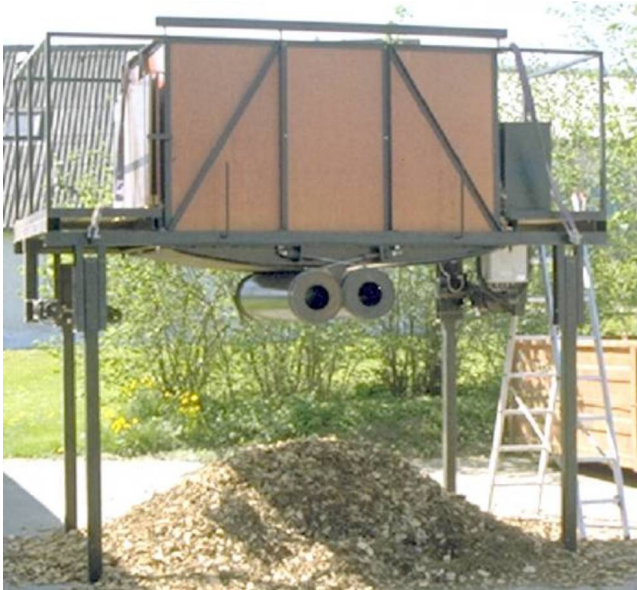
Abbildung 16: Mattsson'sches Brückenbildungstestgerät (Foto: Peter Daugbjerg Jensen)
