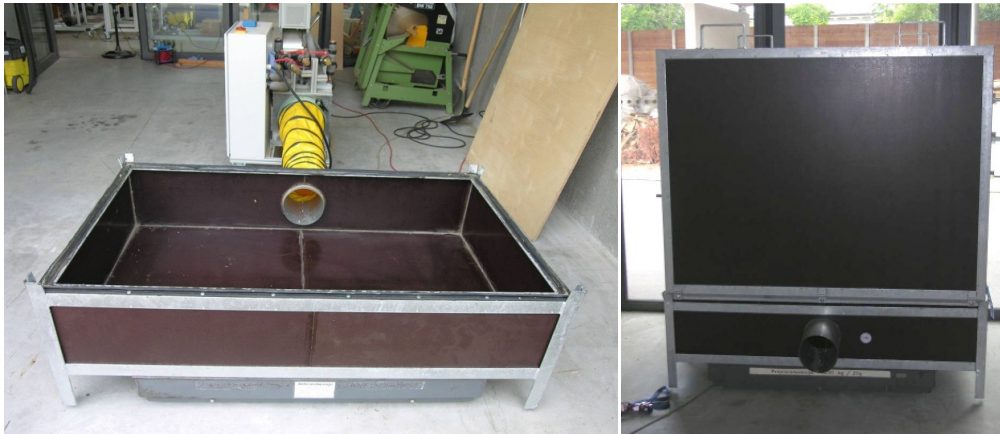
Abbildung 37: Bodengruppe (links) und Schüttgutbox (rechts) des Trocknungsapparates
