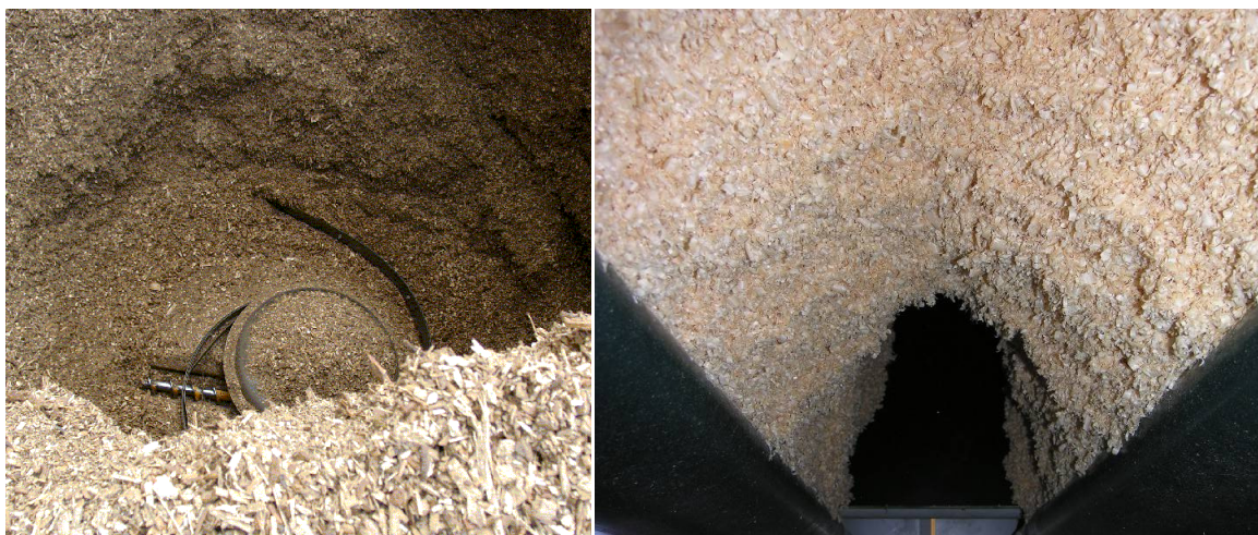
Abbildung 2: Im Lager auftretende Probleme mit den Brennstoffen Hackschnitzeln (links) und Hobelspäne (rechts)
