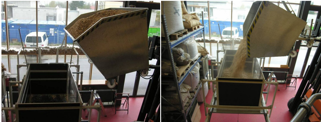
Abbildung 29: Befüllposition des Kippcontainers zu Beginn der Befüllung des Brückenbildungstestgerätes (links) und Befüllposition des Kippcontainers bei Erreichen der maximalen Hubhöhe des Gabelstaplers (rechts)
