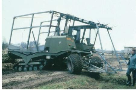
Abbildung 32: Fäll-Bündel-Maschinen Fröbbesta (links) und ESM 901 (rechts) (Foto: SPINELLI)
