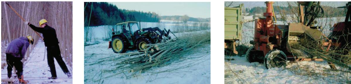
Abbildung 38: Motormanuelles Fällen, Vorkonzentrieren, kranbeschicktes Hacken
