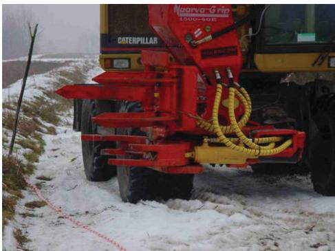
Abbildung 33: Mehrfach-Fällkopf Naarva-Grip 1500-40E an Bagger-Chassis
