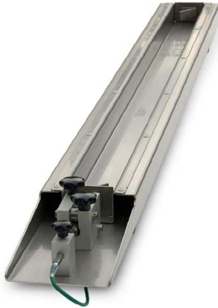
**Abbildung 4-111:** Schwindrinne aus Edelstahl der Länge 1 m ohne Füllung incl. eingesetztem Messfühler.
