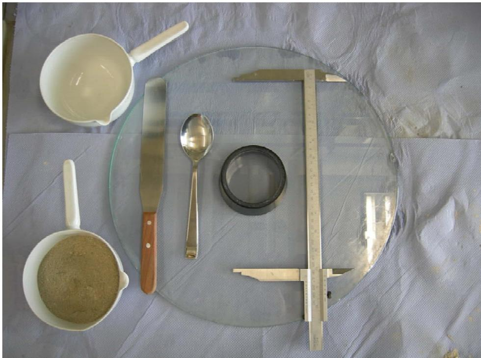
**Abbildung 3-2:** Geräte zur Bestimmung des Fließmaßes: Porzellankasserolle mit vorhomogenisiertem Wasser und Fließmittel, Porzellankasserolle mit vorhomogenisiertem Zement und Silikastaub, Löffel, VICAT-Ring, Abstreichlineal, Glasplatte und Messschieber.
