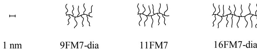
**Abbildung 4-7:** Maßstabsgetreue schematische Darstellung der Molekülarchitektur der untersuchten PCE-Polymere mit Seitenketten aus 7 EO-Einheiten.
