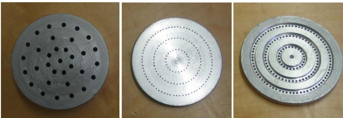
**Abbildung 3-5:** modifizierte Filterplatten der Leimpresse: links die untere, 19,3 mm starke Stahlfilter; Mitte (Oberseite) und rechts (Unterseite): die 5,9 mm starke Filterplatte mit 147 Bohrungen und den Einkerbungen, welche das Filtrat zur Filterplatte leiten.
