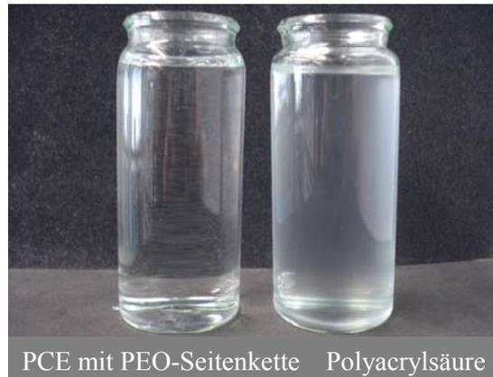
**Abbildung 2-11:** Löslichkeit eines PCEs mit Seitenketten (links) in Zementleimporenlösung im Vergleich zu einem PCE ohne Seitenketten (Polyacrylsäure) (rechts).
