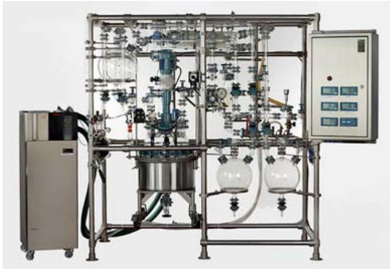
**Abbildung 4-72:** Glasreaktoranlage zur PCE-Synthese im 20 Liter Maßstab incl. Thermostaten zur Temperierung des Reaktionskessels.
