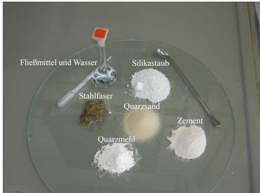
**Abbildung 2-26:** Ausgangsstoffe für die Herstellung von UHPC als Feinrezeptur: Fließmittel, Wasser, Silikastaub, Zement, Quarzmehl, Quarzsand und Stahlfasern.
