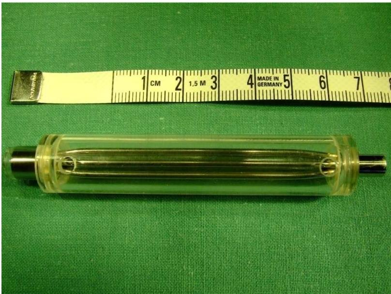
**Abb. 2.8** Wärmetauscher
