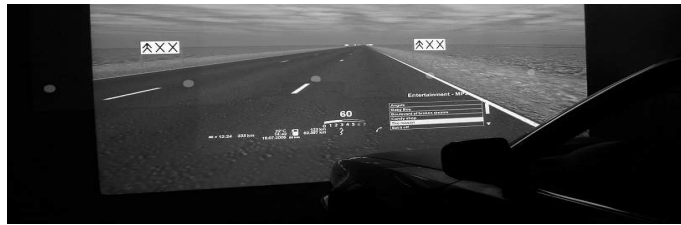
Abbildung 1: LCT-Fahraufgabe, HUD und PDT-Punkte (fünf Positionen im Bereich von 0^\circ und \pm 23^\circ des Sehfeldes)
