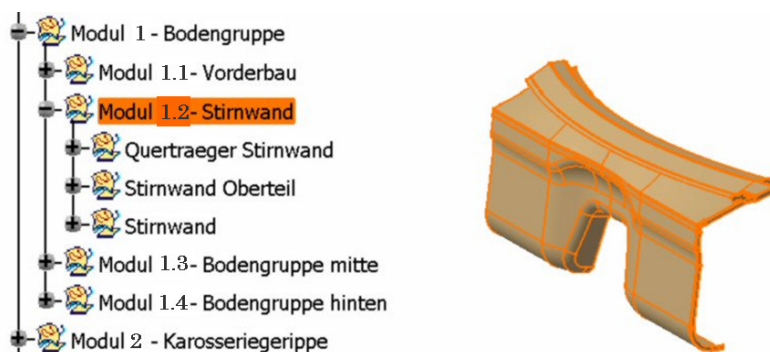
Bild 5-5: Hierarchische Untergliederung des Modellbaums der PaKoBG in Eindokumenten-Technik.
