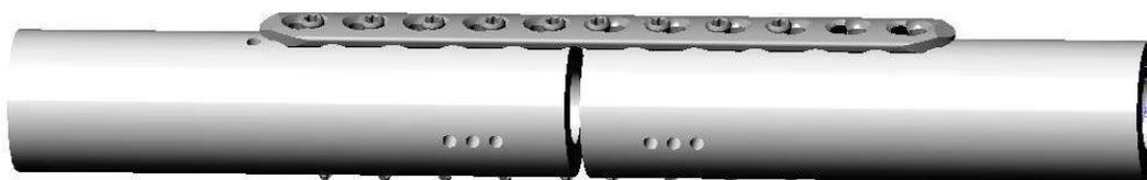
**Abbildung 3.5:** 3D CAD-Zeichnung des Osteosynthesemodells mit humanem Implantat und veterinärer Schraubenanordnung (LCP hum 5/4).
