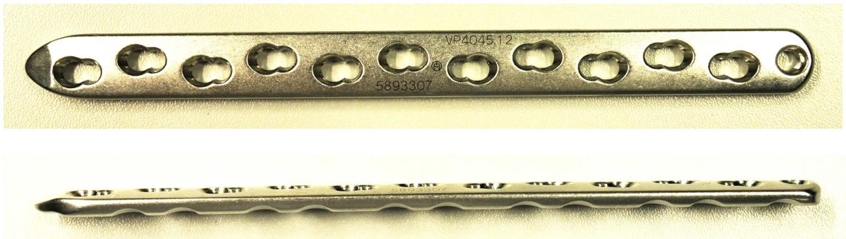
**Abbildung 3.1 A:** Locking Compression Plate (LCP) 3.5, 11 Löcher, L 150mm aus Titan für die humane Anwendung. **B:** Locking Compression Plate (LCP) 3.5, breit, 12 Löcher, L 159mm aus Stahl für den veterinären Bedarf.
