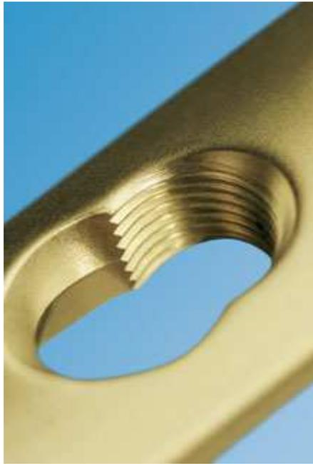
**Abbildung 2.7:** Schraubenloch der LCP. Im rechten Teil des Lochs ist ein Gewinde für den Einsatz von winkelstabilen Schrauben geschnitten. Der linke Teil weist kein Gewindemechanismus auf und ermöglicht die Fixierung der Platte mit herkömmlichen Kortikalisschrauben [80].
