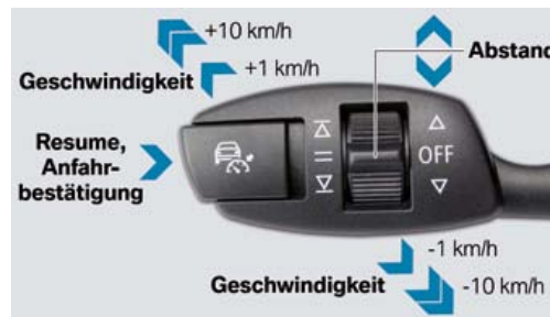
Abbildung 2.1.: Lenkstockhebel für ACC [PSE07]
