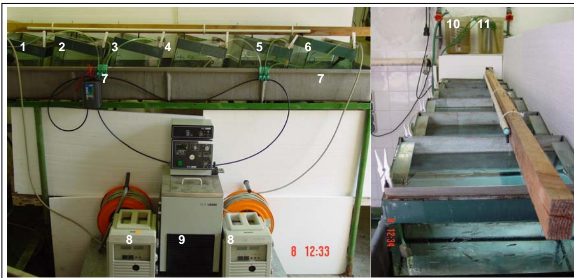
Abbildung 11: Versuchsanordnung zur Temperaturabhängigkeit des Fischwachstums. 1-6 = Aquarien mit alternierenden Temperaturstufen; 7 = Belüftung; 8 = Dauermessgeräte; 9 = Kühlaggregat; 10 = Zulauf Kaltwasser mit Kühlschlange; 11 = Zulauf Warmwasser mit thermostatgesteuerten Heizstäben.
