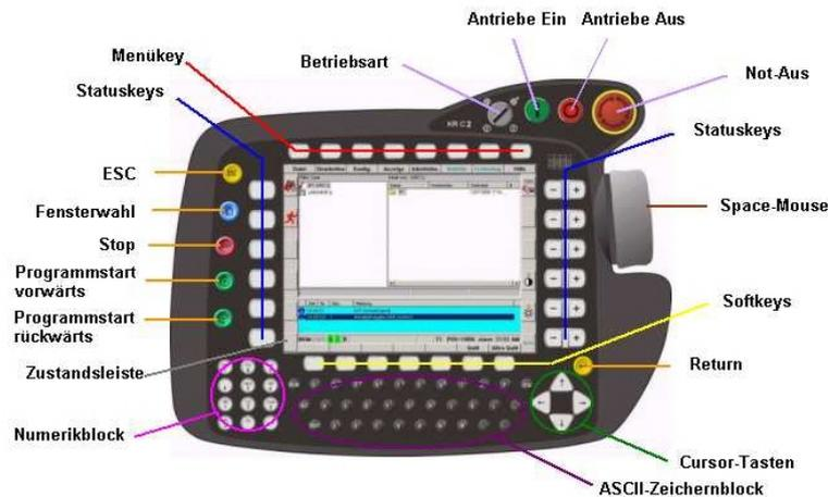
Abbildung A.2: Das KUKA Control Panel (Abbildung: KUKA).
