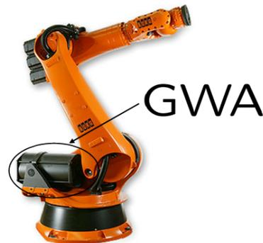
**Abbildung 2.13:** Gewichtsausgleich (GWA) des KR210 (Abbildung: KUKA).
