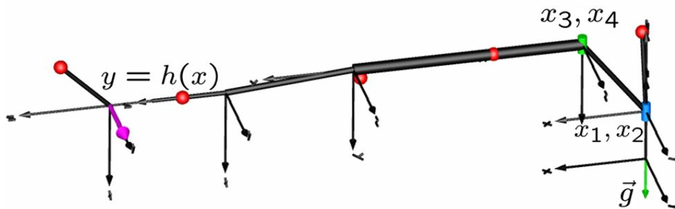
**Abbildung 3.1:** Schematische Darstellung des stark vereinfachten Modells des KR210 mit vier Zuständen. Ausgang  $y$  ist die kartesische Verschiebung in  $y$ -Richtung (lila Pfeil) am Handflansch, Eingang  $u$  ist das Motormoment  $\tau_{m,1}$  bei Achse 1 (blaues Gelenk). Zusätzlich gibt es eine Kippsteifigkeit  $(c_{e,1}, d_{e,1})$  bei Achse 2 (grünes Gelenk).
