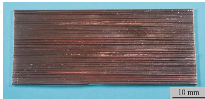
Abb. 3-7: UD-Lage nach dem zweiten galvanischen Schritt
