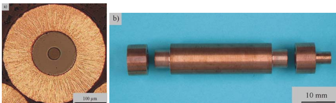
Abb. 3-4: a) Galvanisch beschichtete Faser, b) Cu-Kapsel
