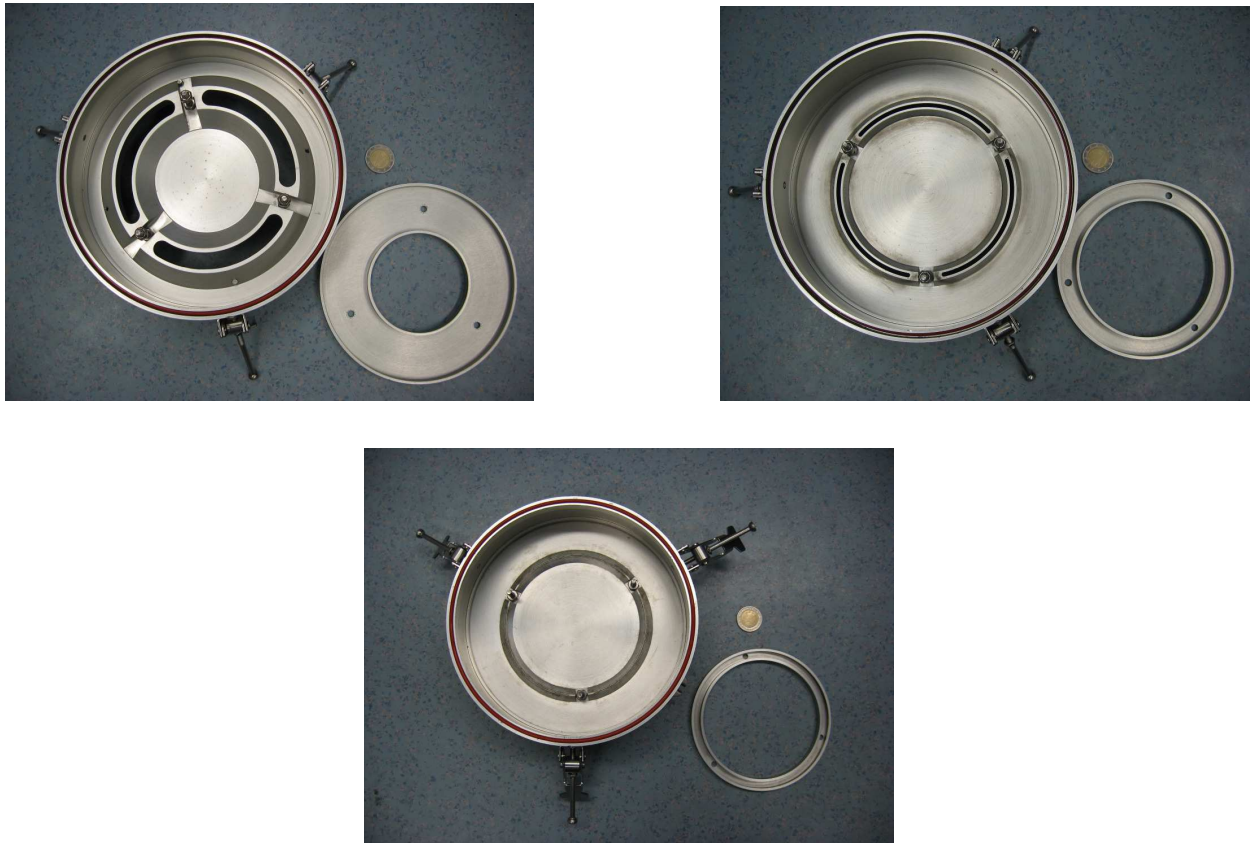
Abbildung 2.1.3: Einzelne Etagen des ChemVol®- Samplers mit abmontierter Aufprallplatte ohne Sammelsubstrat/ Aufsicht von unten
