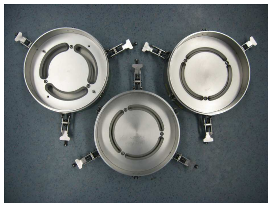
Abbildung 2.1.2: Einzelne Etagen des ChemVol®- Samplers/ Aufsicht von oben
