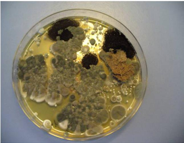
**Abb. 4: Schimmelbefall im Laborversuchsstand (*Penicillium* und *Aspergillus niger*) an der kriechkellerseitigen Holzweichfaserplatte im Bereich ohne Bodenabdeckung**
