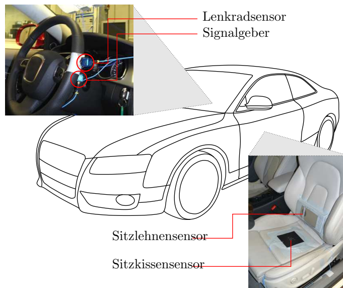
Abb. 6.4: Messpositionen der Beschleunigungssensoren
