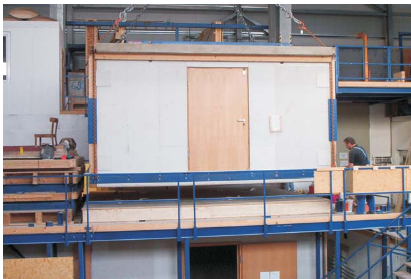
Abbildung 1.3: Deckenprüfstand des ift Schallschutzzentrums, Rosenheim
