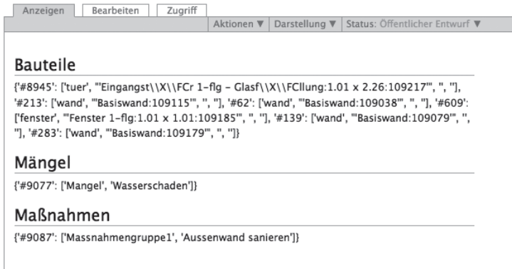
Abb. 5.11: Ausgabe des Parsers: Informationen zu Bauteilbezeichnungen, Mängeln und Maßnahmen zu deren Behebung
