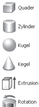
Abb. 2.5: Grundkörper, Extrusionskörper und Rotationskörper
