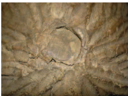
abgeschlagener Kopfdübel (Inv.-Nr. 294)
