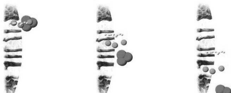
Abb 2: Auftrennung der Moleküle der mobilen Phase anhand der Molekülgröße (Molekulargewicht)
