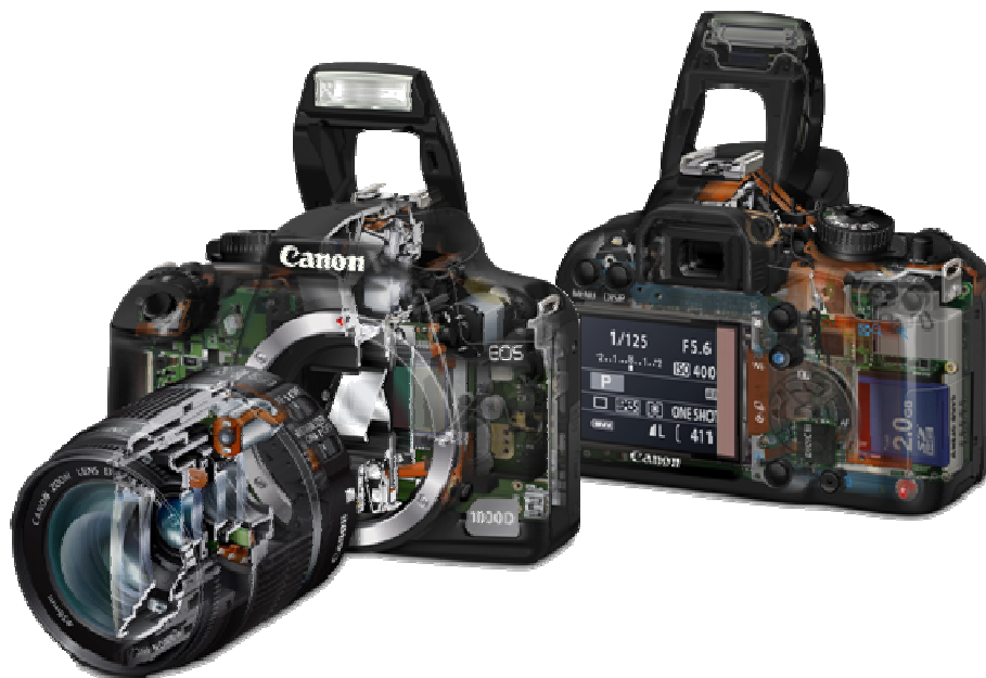
Bild 3-8: Digitale Spiegelreflexkamera als Beispiel eines komplexen mechatronischen Systems (Bilder mit freundlicher Genehmigung von Canon)
