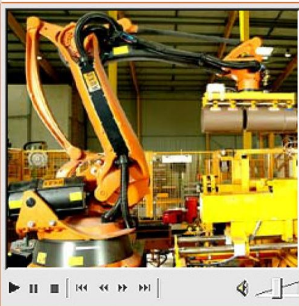
Handhaben von Schamotteröhren
