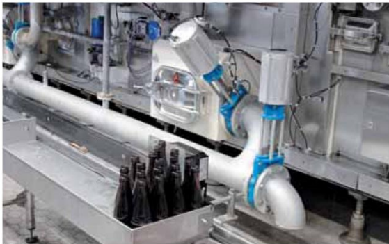
Prozessantriebe von Festo vom Typ DLP: In der Flaschenwaschanlage Innoclean von KHS zum Öffnen und Schließen der Klappen in der Reinigungsaußen-Zuführung
