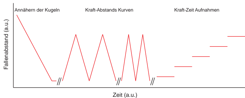
Abbildung 2.9: Typischer Verlauf eines Faltungsexperiments. Gezeigt ist die Position des AOD-Strahlengangs als Funktion der Zeit. Das Experiment ist in drei Phasen unterteilt. Links: Annäherung der Kugeln zum Zusammenbau der Kugel-DNA-Protein Hanteln und zum Aufnehmen der Crosstalk-Effekte. Mitte: Verfahren der Kugel mit verschiedenen konstanten Geschwindigkeiten zur Aufnahme von Kraft-Abstands-Kurven. Rechts: sukzessive veränderter Fallenabstand für Kraft-Zeit-Aufnahmen.
