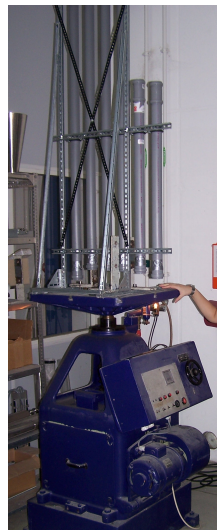
Abbildung 3.9: Rütteltisch zur Prüfung der Auswirkungen von Beschleunigungsbelastungen auf unterschiedlich hohe Festbettschüttungen.
