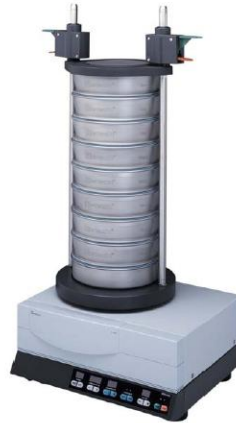
Abbildung 3.2: Rüttelsieb zur Untersuchung der Abriebfestigkeit.
