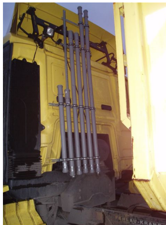
Abbildung 3.14: Montage verschieden hoher Festbettschüttungen ans Führerhaus eines LKW zur Beurteilung der mechanischen Langzeitstabilität.
