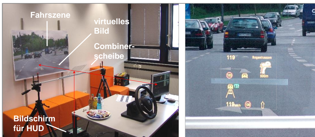
Abbildung 33: Usability-Versuch Tischaufbau (links) und virtuelles Bild (rechts)
