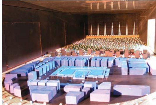
Abbildung 5.1: Windkanalexperiment am Laboratorium für Gebäudeaerodynamik, Institut für Hydromechanik, Universität Karlsruhe
