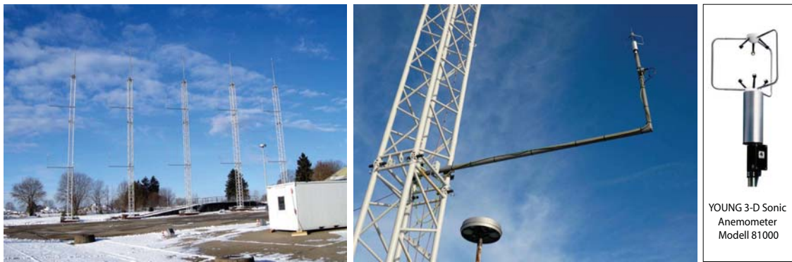
Abbildung 6.11: Windmessmasten, ausgestattet mit 15 Sonic Ultraschallanemometern
