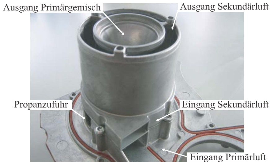
Abbildung 5.14: Brennertopf ohne Flammenhalter mit Schnittstellen für das Netzwerkmodell.
