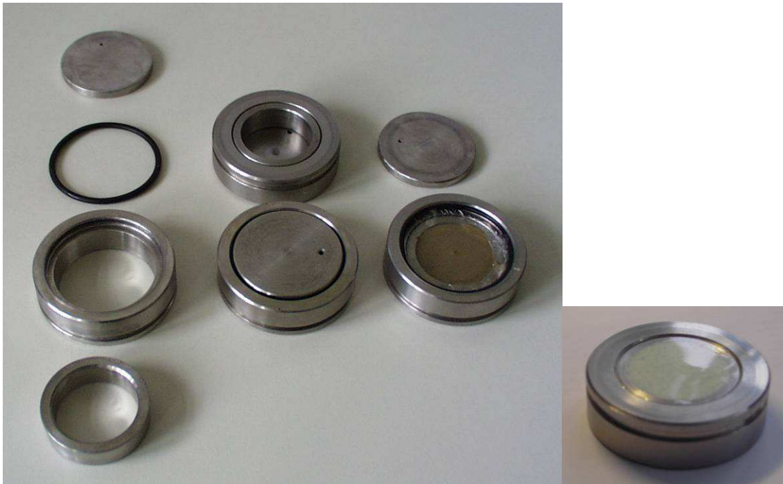
Abbildung 2: Aufbau und Beladung des Probenträgers aus Edelstahl („back loading“) für die zyklischen XRD-Langzeitmessungen während der Zementhydratation (Großes Bild links: Probenträger komplett zerlegt; Mitte: Probenträger leer montiert; rechts: Probenträger mit Zementpaste beladen, hintere Abdeckung offen; kleines Bild: Probenträger gefüllt, mit Folie abgedeckt und komplett montiert in Messlage)
