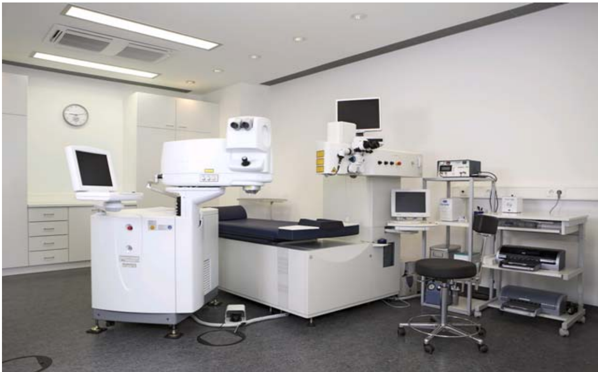
Abbildung 8: Die Behandlungseinheit mit IntraLase FS60 Femtosekunden-Laser (links) und schwenkbarer Liege des Schwind Esiris Excimer-Lasers (rechts) in den Räumen des Visumed Zentrum München (eigene Abbildung)
