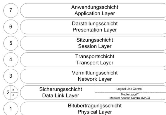
Abbildung 2.5: Das ISO/OSI-Referenzmodell für Netzwerkarchitekturen
