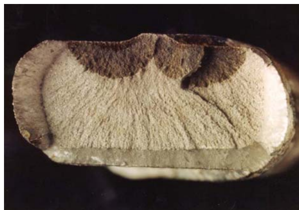
Bild 2.5: Typische Bruchfläche infolge SRK mit zwei dunklen, linsenförmigen Anrissen und mattgrauer Restbruchfläche, aus [Nürnberger u. a. 1994]
