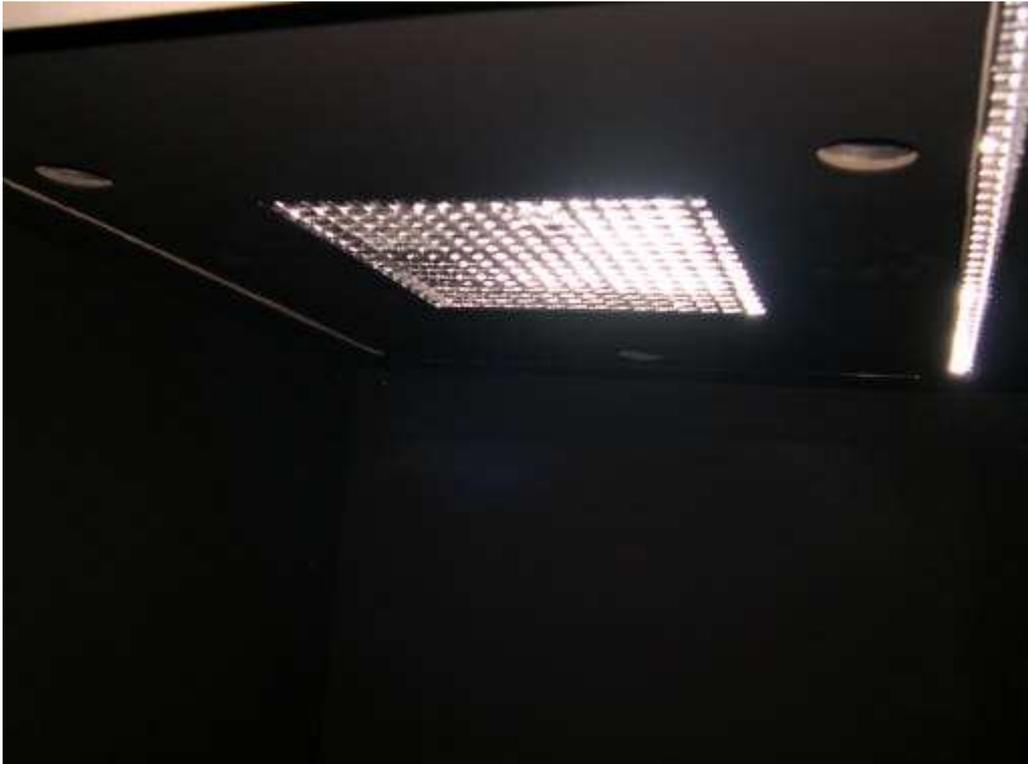
/147/ Deckenansicht eines Innenraummodells mit den drei Beleuchtungseinrichtungen (Spiegelrasterdecke, Wandfluter, Strahler)
