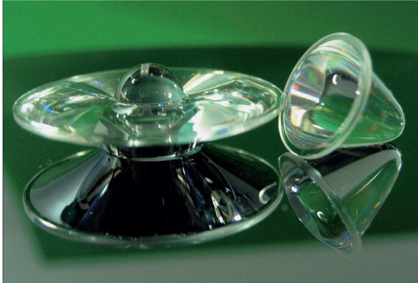
/61/ Diamantgedrehte Prototypen für RXI (links) und TIR-Konzentrator (rechts)
