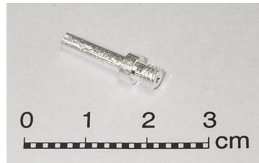
Abb. 4.14: Der Silberstift nach dem Tempern bei 790 °C.
