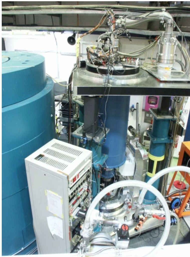
Abb. 6.26: Der Kryostat an der Neutronenquelle in Berlin. Links erkennt man die Abschirmung des Monochromators, im unteren Bereich die Plattform für den Detektor, der um mehr als 180^\circ um die Probe geschwenkt werden kann.
