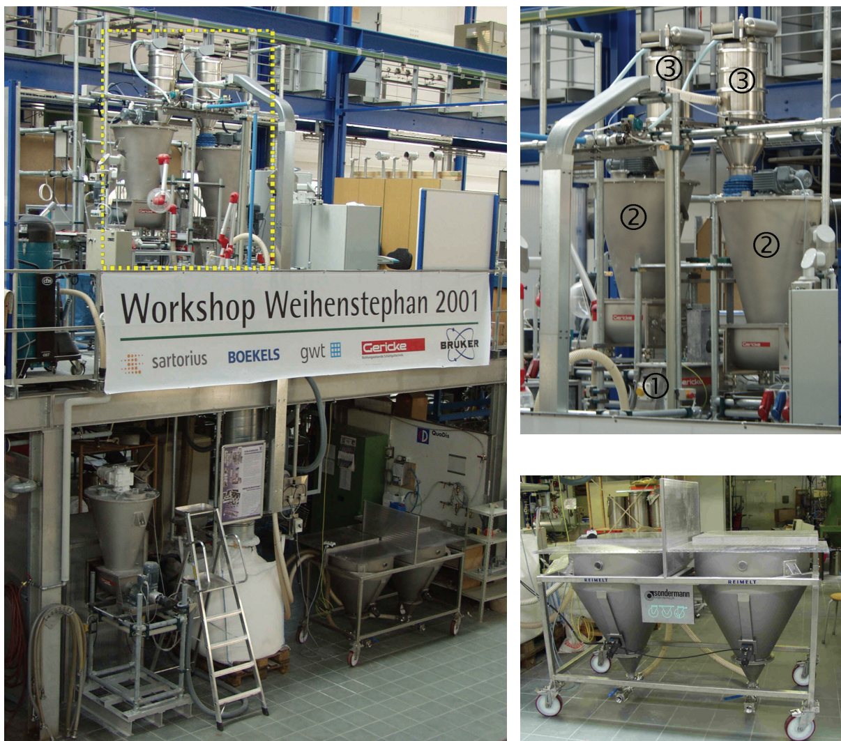
Abbildung 4.5: Frontansicht der Versuchsanlage (① kontinuierlicher Mischer GCM500 , ② volumetrische Dosierer GAC132 , ③ Vakuumpörderer) [3] 12
