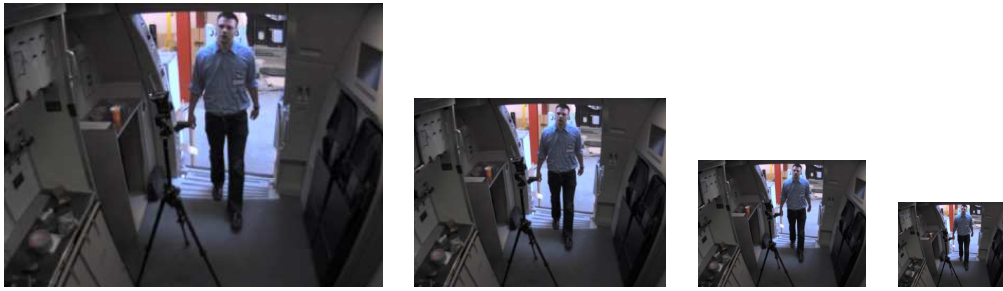
Abbildung 2.2: Auflösungspyramide: Das ursprüngliche Bild wird in verschiedenen Größen skaliert.
