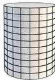
Abbildung 4.14: Bei Projektion auf die Bildebene verändern sich horizontale Frequenzen einer Textur je nach Winkel, vertikale Ortsfrequenzen sind jedoch invariant.
