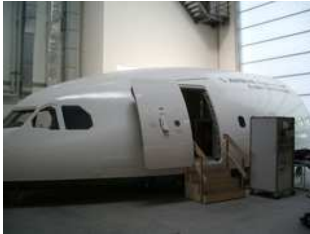
Abbildung 3.17: Der SAFEE-Simulationsaufbau für den Test der Authentifikation unter Realbedingungen.
