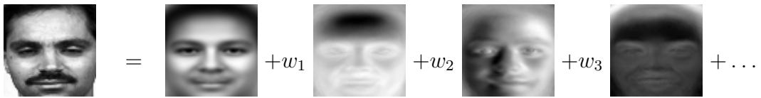
Abbildung 2.15: Beschreibung von Gesichtern durch Linearkombination der Eigenfaces
