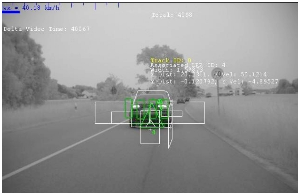
Bild 7.15: Multisensorielles Tracken des Fahrzeugs
