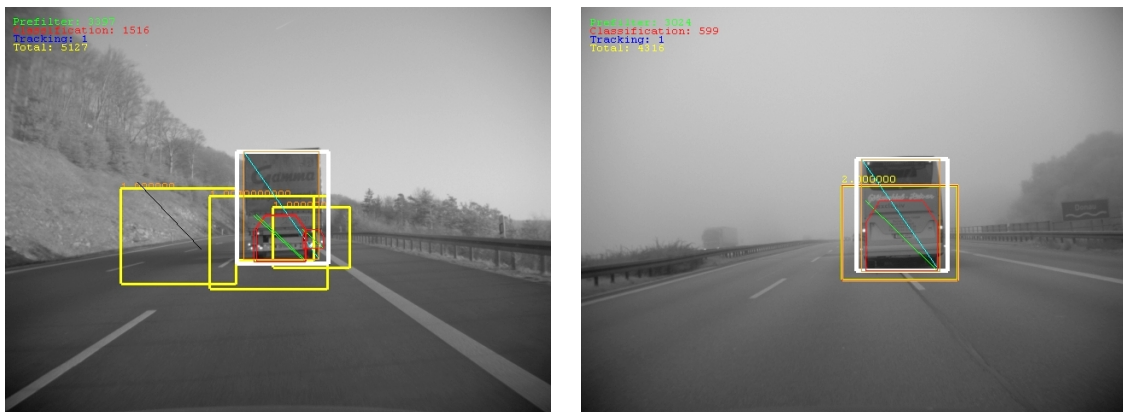
Bild 6.18: Fehlklassifikationen innerhalb von Heckansichten
