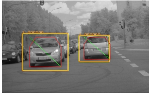
Bild 6.17: Gegenverkehr erzeugt Fehldetektion
