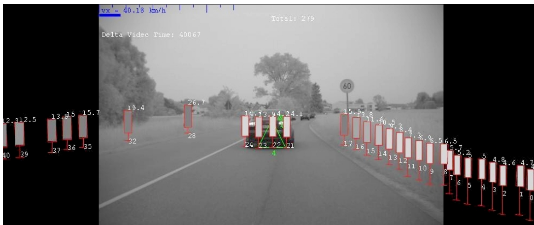
Bild 7.13: Sensorrohdaten ins Bild projiziert
