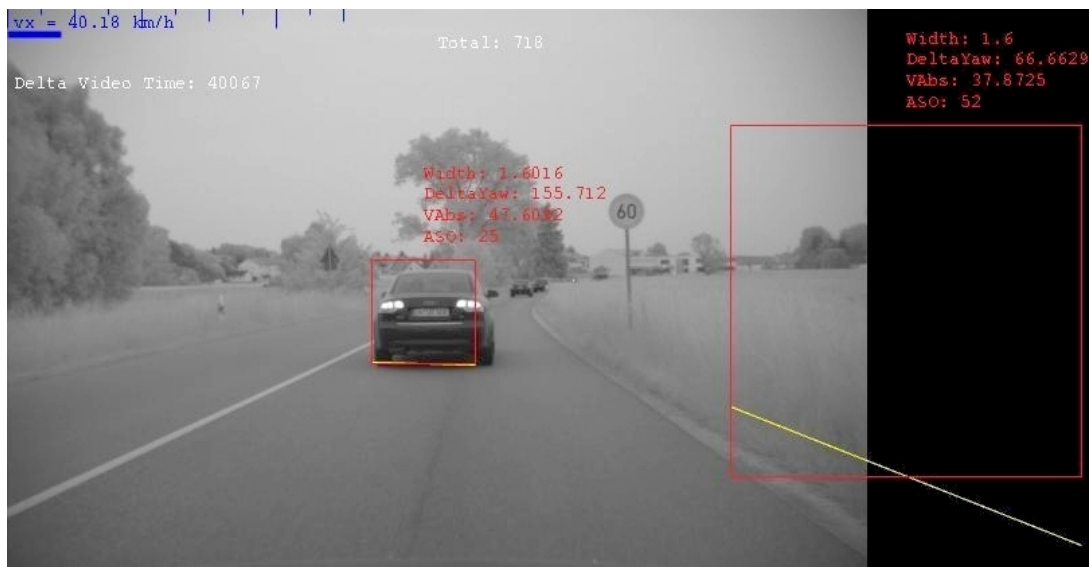
Bild 7.14: Detektion über Lidarsignale
