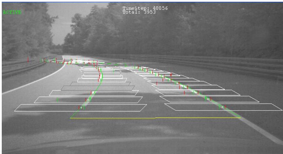
Bild 7.1: Beispiel einer zu großen Vorausschauweite in einer engen Kurve
