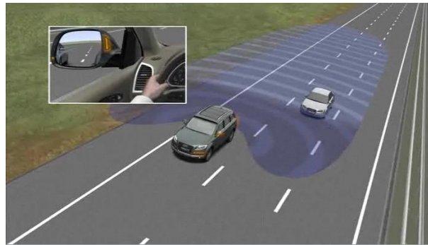
Bild 2.5: Spurwechselassistent (Quelle: Audi AG [2])
