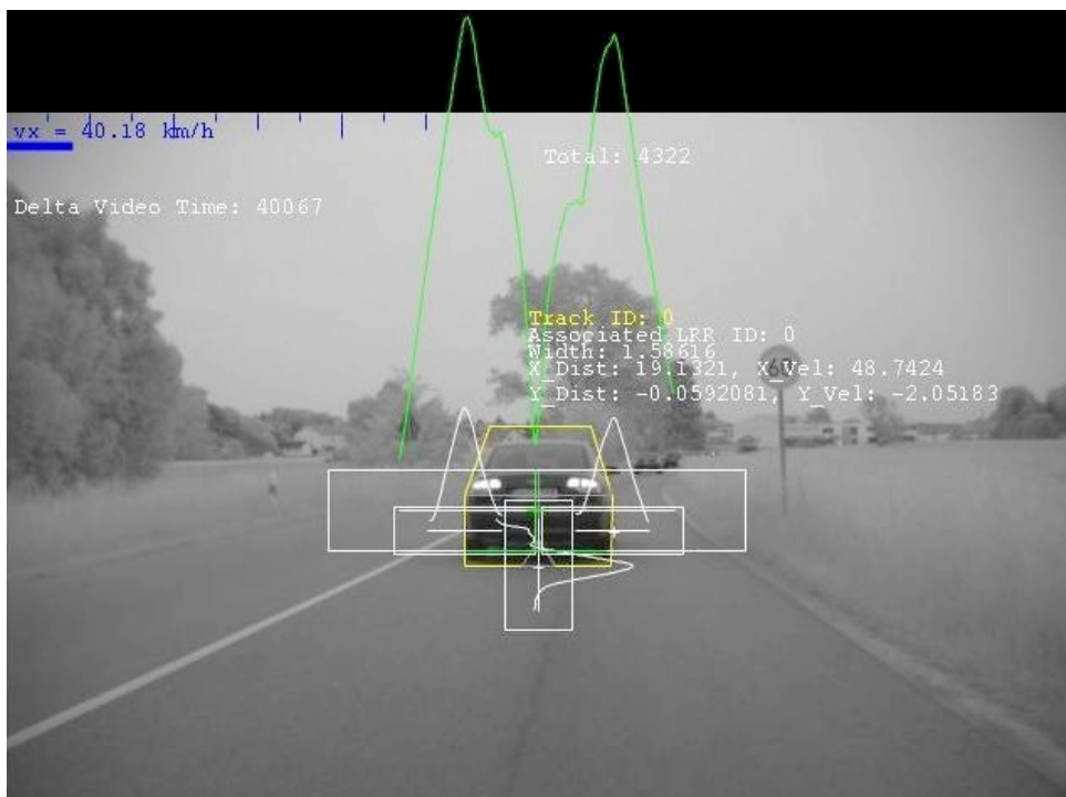
Bild 7.16: Operatorverläufe der Bildverarbeitung des Fahrzeugtrackers
