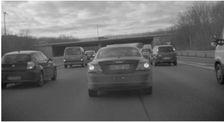
Bild 7.9: Verdeckung der Fahrspurmarkierung
