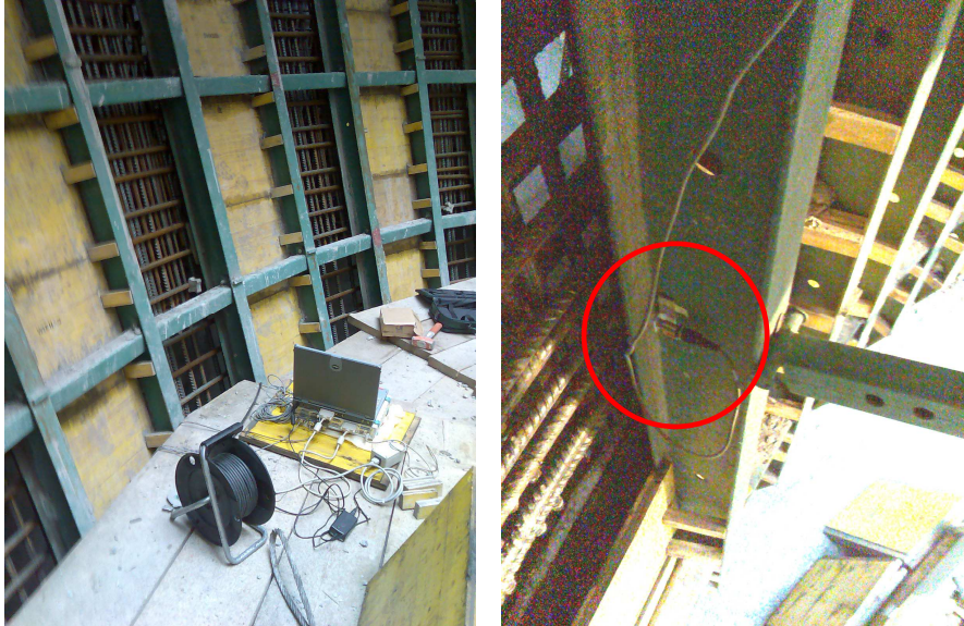
Abbildung 5-12: Aufbau Messtechnik und Lage der Beschleunigungsaufnehmer
