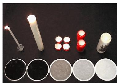
Abbildung 6.8: Qualitativer Vergleich der Verschmutzung eines Glasfaserfilters durch unterschiedliche Kerzen (von links nach rechts) Opfer-Kerze, Altar-Kerze, Opferlicht (klein), Opferlicht (groß), Novene-Kerze, aus [Schellen, 2002]
