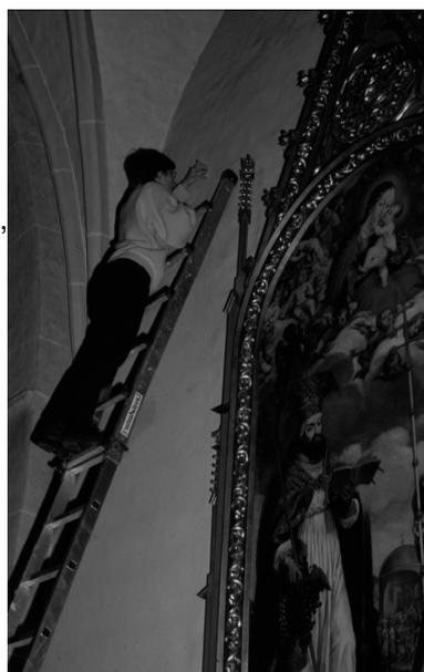
Abbildung 4.3: Befestigung eines HOBO Datenloggers zur Messung der Oberflächentemperatur an der Wand
