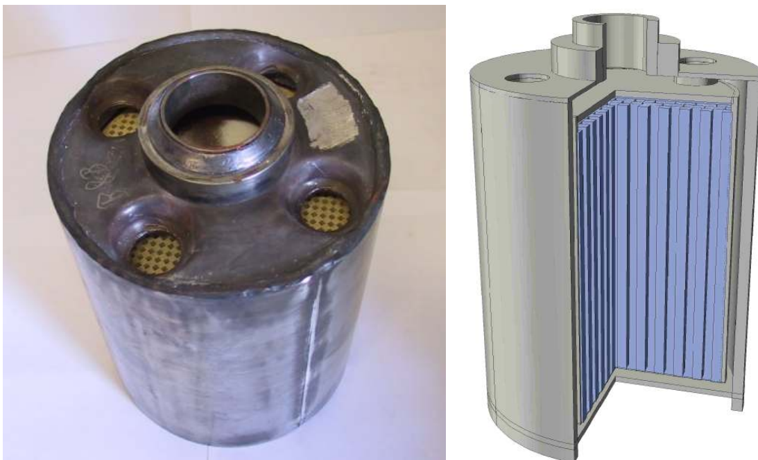
Abbildung 14: Draufsicht (links) und Schnittzeichnung (rechts) von Partikelfiltersystem „c“ - keramischer Monolith in speziellem Gehäuse (142 mm Durchmesser, 200 mm Länge)
