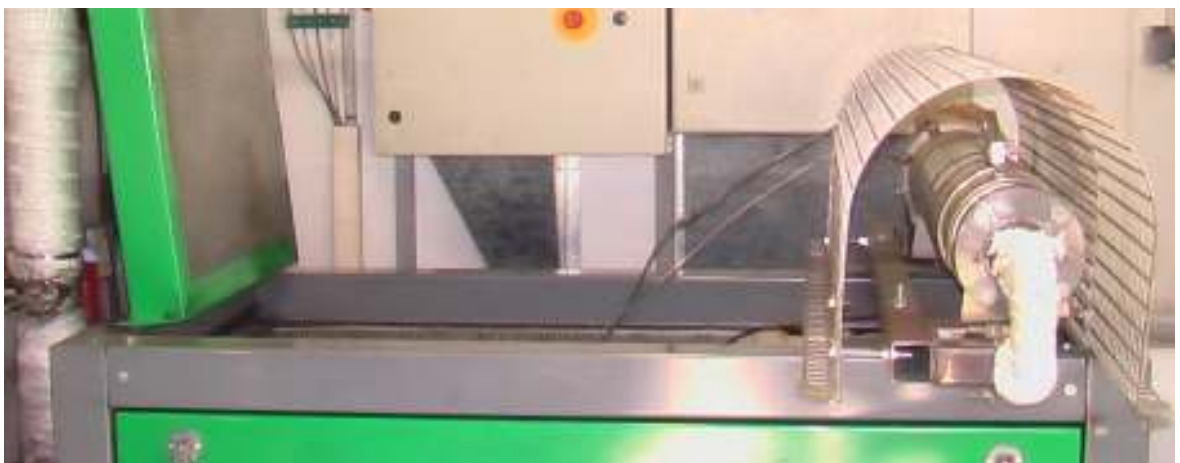
Abbildung 18: Veränderte Abgasführung für Partikelfiltersystem „e“
