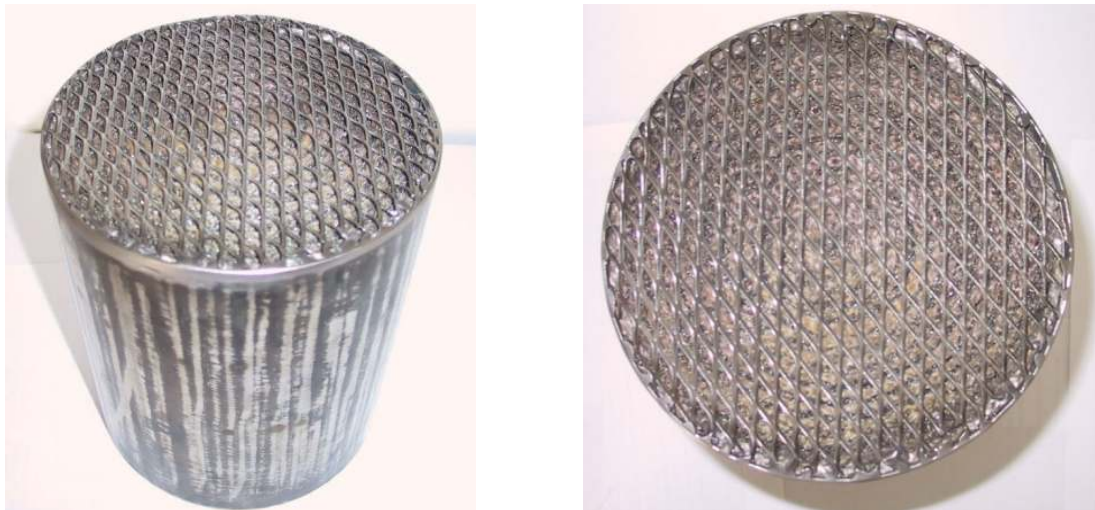
Abbildung 13: Bild links: Filtersystem „bb“ - gewickeltes Draht-/Keramikfilamentgestrick in Edelstahlgehäuse (150 mm Durchmesser, 200 mm Länge); Bild rechts: Draufsicht auf Filtersystem „bb“
